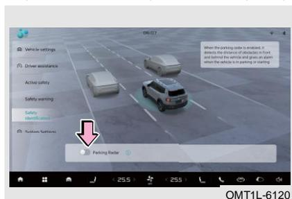
Переключите питание автомобиля в режим ON, нажмите переключатель парковочного радара, чтобы включить систему парковочный радар. Если он не находится в режиме R, нажмите кнопку еще раз, чтобы выйти из системы парковочный радар.
