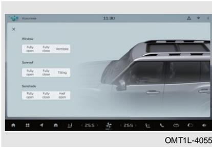
Переключите питание автомобиля в режим ON, через оконный экран на мультимедийном дисплее щелкните по нему, чтобы отрегулировать солнцезащитный козырек, люк на крыше и окно.
