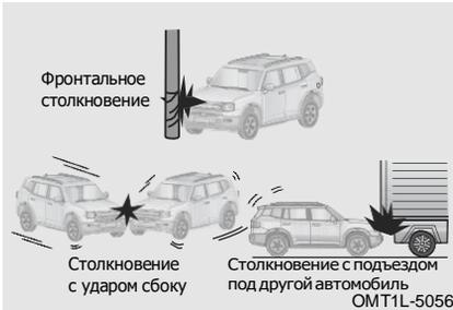
Фронтальная подушка безопасности водителя и фронтальная подушка безопасности переднего пассажира могут не сработать, если передняя часть автомобиля ударится о телеграфный столб, попадет под грузовик или коснется бокового удара.
