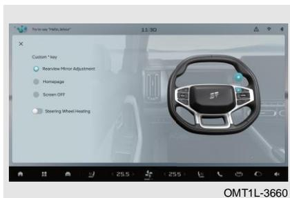
На экране пользовательской кнопки рулевого колеса выводится выбранная по умолчанию регулировка зеркала заднего вида, главная страница, выключение экрана, нагрев рулевого колеса.
