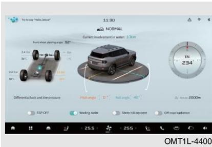
На экране внедорожного регулятора проверьте угол поворота передних колес автомобиля, состояние блокировки дифференциала, температуру и давление в шинах, режим вождения автомобиля, угол крена и наклона автомобиля, высоту, атмосферное давление, компас и т.д.
