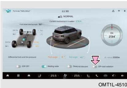
На экране режима по бездорожью включите переключатель охлаждения для бездорожья. Когда двигатель запущен и условия охлаждения удовлетворены, вентилятор охлаждения работает на максимальной скорости.
