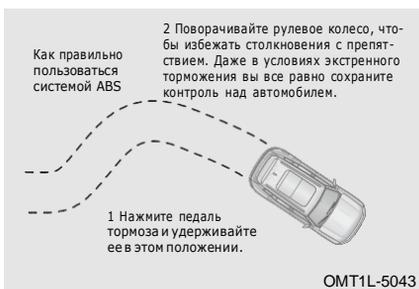
ABS не работает при обычном торможении и немедленно включается только при экстренном торможении (– педаль тормоза пульсирует с шумом, обеспечивая эффективность торможения и рулевого управления, если места достаточно, автомобиль также может объезжать препятствия). Никогда не отпускайте педаль тормоза в этом случае.
