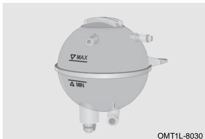
При холодном двигателе уровень охлаждающей жидкости должен находиться между отметками «MIN» и «MAX». Если уровень находится на отметке «MIN» или ниже нее, долейте охлаждающую жидкость и немедленно обратитесь на авторизованную станцию технического обслуживания Jetour для проверки и ремонта.
