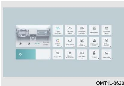
На экране быстрого меню отрегулируйте яркость дисплея, установите режим вождения, отрегулируйте наружное зеркало заднего вида, откройте дверь багажного отделения с электродвигателем и т.д.
