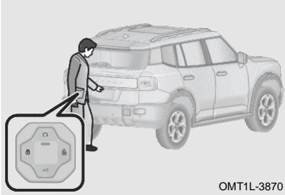
После разблокировки центрального замка подойдите к задней части автомобиля и нажмите наружный выключатель двери багажного отделения, загорятся поворотники и дверь багажного отделения с электроприводом откроется/закроется.
