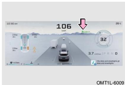
1. Запустите автомобиль, когда скорость автомобиля превысит 15 км/ч или за ним последует автомобиль, автомобиль автоматически перейдет в режим круиза, и загорится индикатор «
