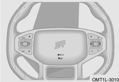
Чтобы подать звуковой сигнал, нажмите на область возле значка клаксона на рулевом колесе.
