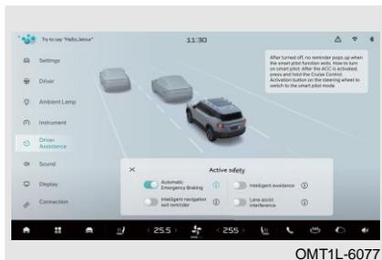
В системе помощи при движении по полосе движения, LDW можно включить/ выключить, нажав на мультимедийный дисплей.
